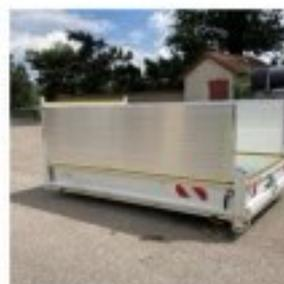
Un camion du service technique vieux de 20 ans a été remplacé. Le nouveau camion est équipé du système Ampiroil qui permet de déposer les bennes au sol. Cela évite de monter et descendre les charges à transporter et facilite le travail des employés.
